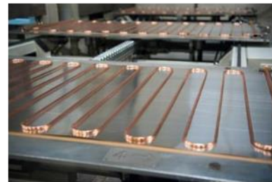
Capteur solaire thermique
